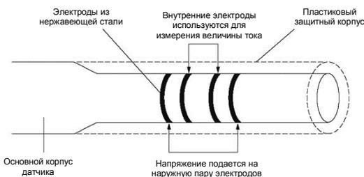
В датчиках STCON3 используется 4-х электродный потенциометрический метод измерения электропроводности, при котором на корпусе датчика располагаются четыре электрода из нержавеющей стали. Такая конструкция полностью исключает поляризацию, которая имеет место при использовании 2-х электродного амперометрического метода. Кроме того, неполяризующийся датчик позволяет измерять электропроводность в более широком диапазоне, поскольку на его характеристики не влияет электролиз.
